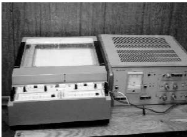
Рис. 2.6. Апаратура для дослідження кровотоку методом водневого кліренсу – аналізатор кліренсів (АК–01) та двохкоординатний самописець.
