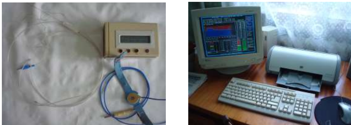
Рис. 2.10. Ацидограф АГ ІД-02 з рН-мікрозондом та програмований комп'ютер.
