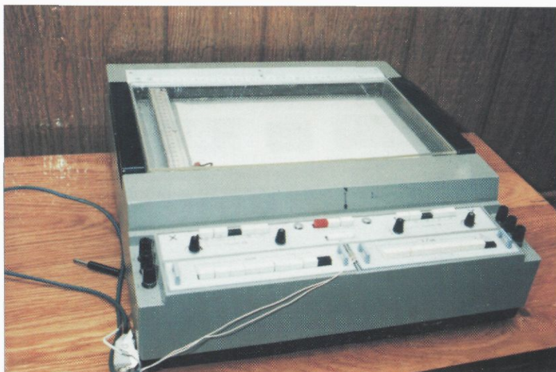
Мал. 5.1.3. Апаратура для дослідження кровобігу методом водневого кліренсу: А – аналізатор кліренсів (АК-01); Б – двохкоординатний самописець.
