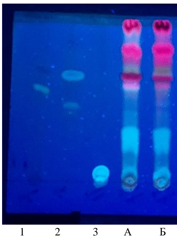
Рисунок 3.4. - Фото ТШХ-хроматограм стандартних зразків гідроксикоричних кислот (1 – розмаринової кислоти, 2 – кофейної кислоти; 3 – хлорогенової кислоти) і метанольних витягів пагонів Vitex agnus-castus (A) і Vitex negundo (B) (при \lambda=366 нм) Рухома фаза: етилацетат – мурашина кислота безводна – вода (15:1:1); дериватизація: 1 % розчином AlCl_3
