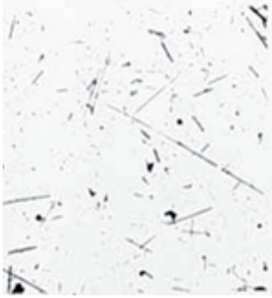
Рис. 34. Кроцидоліт-азбест або блакитний азбест (\text{Na}_2\text{Fe}_3^{2+}\text{Fe}_2^{3+})\text{Si}_8\text{O}_{22}(\text{OH})_2 .
