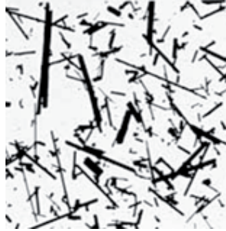
Рис. 35. Амосит-азбест (\text{Fe}_2 +, \text{Mg})_7\text{Si}_8\text{O}_{22}(\text{OH})_2 .
