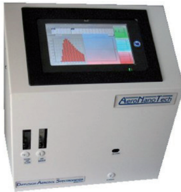
Рис. 69. Дифузійний аерозольний спектрометр ДАС 2702.
