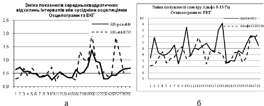
Рис. 6.3. Зміна показників синхронно зареєстрованих артеріальної осцилограми та ЕКГ: а – середньоквадратичні відхилення інтервалів між сусідніми осциляціями осцилограми та ЕКГ, помноженої на 10000 – 31 обстежений; б – потужність альфа 8–13 Гц осцилограми та альфа 8–13 Гц ЕКГ, помноженої на 1000 (репрезентативна вибірка) – 28 обстежених.
