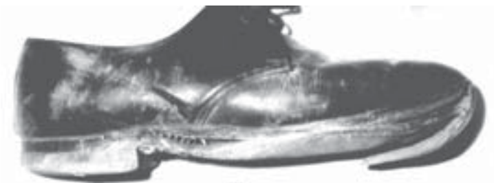
Рис. 831. Пошкодження правого напівчеревики у випадку, що на рис. 830, – відрив передньої частини підошви, розрив її шва в ділянці підйому.
