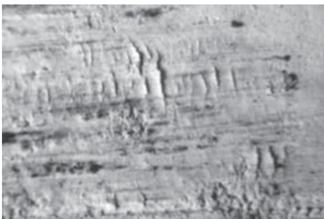
Рис. 695. Експериментальні сліди ковзання на щільному картоні. У поперечному до них напрямку розташовані численні паралельні одна одній тріщини з піднятим краєм у напрямку руху слідосприймаючої поверхні.
