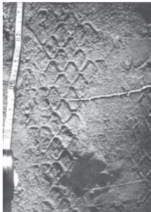
Рис. 699. Сліди протектора на ґрунті у випадку, що на рис. 697, 698. Вони лише частково відображають малюнок протектора колеса. У слідах відбилась центральна частина протектора і відсутні його краї.
