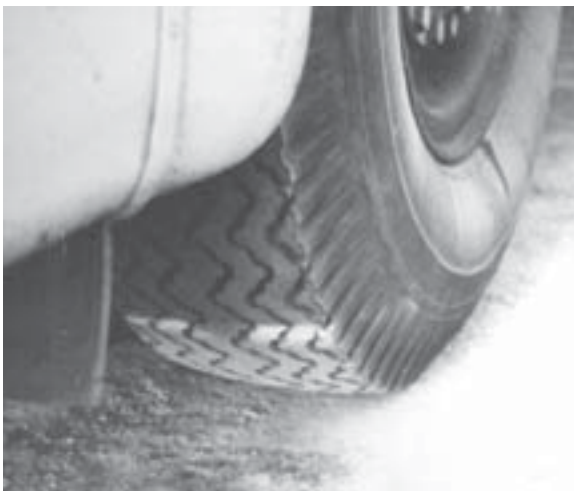
Рис. 510 а, б. Протектор шини міжміського автобуса “Ікагус”. Слід протектора, залишений таким колесом.
