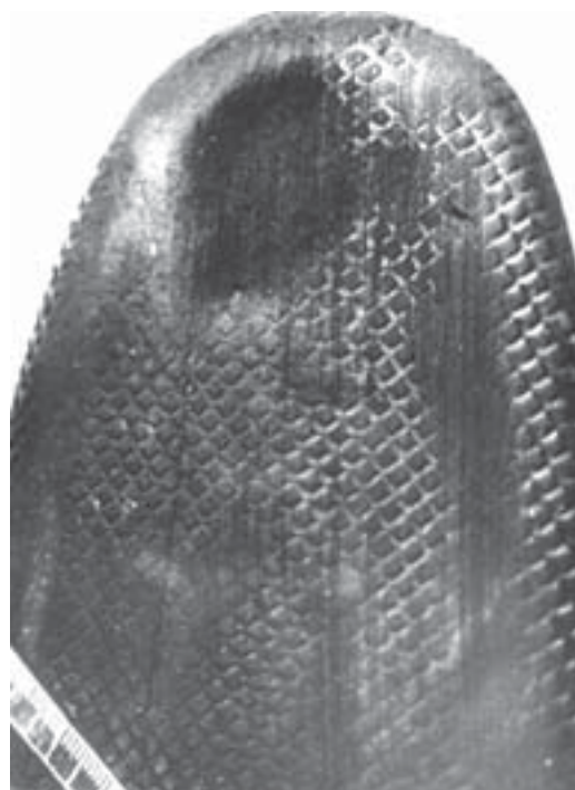
Рис. 690. Об'єкт, що на рис. 689, знятий в ультрафіолетових променях. Фактура підошви і сліди ковзання виражені чіткіше.
