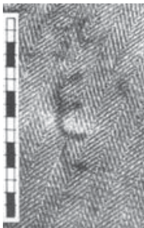
Рис. 533. Забруднення спіралеподібної форми на штанах – відбиток пружини сидла велосипеда, що утворився в результаті удару і переїзду автомашиною велосипедиста.
