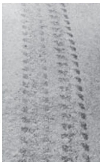
Рис. 513. Слід двох спарених коліс вантажної автомашини ЗІЛ. Протектор підвищеної прохідності.
