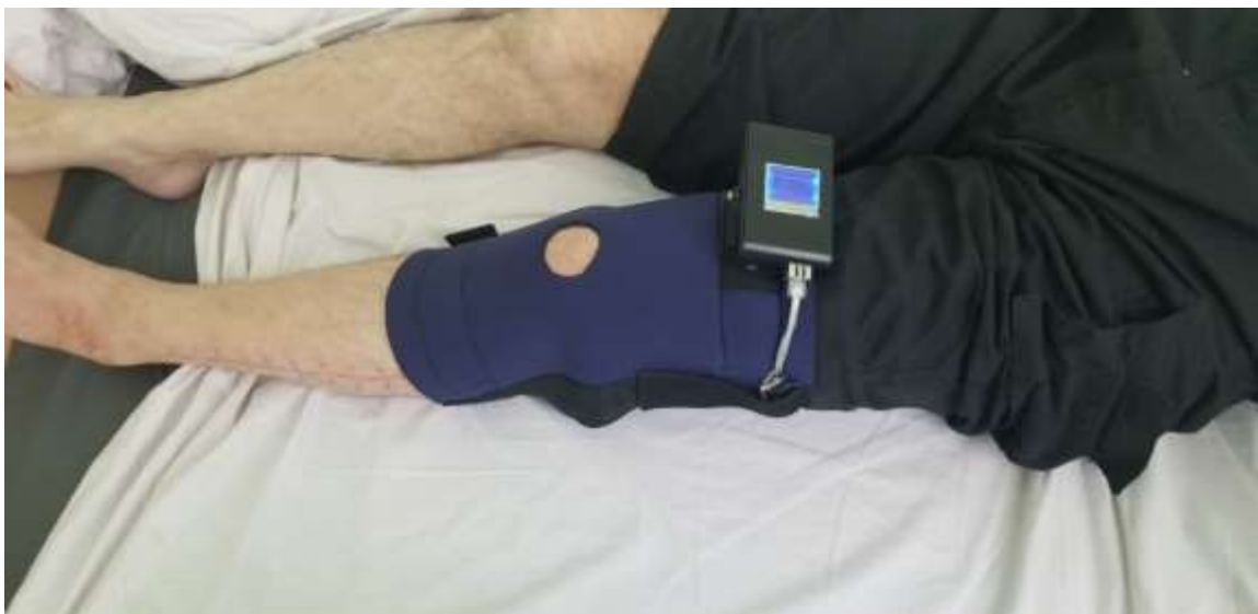
Рисунок 5.1 – Портативний пристрій для дистанційного моніторингу фізіологічних параметрів нижньої кінцівки.
