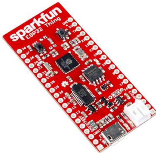
Рисунок 5.2 – Платформа Arduino Sparkfun Thing Esp32
