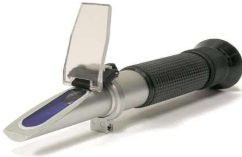
Рисунок 2.2 – Портативний медичний рефрактометр для вимірювання питомої густини сечі, плазми крові і білка сироватки крові
