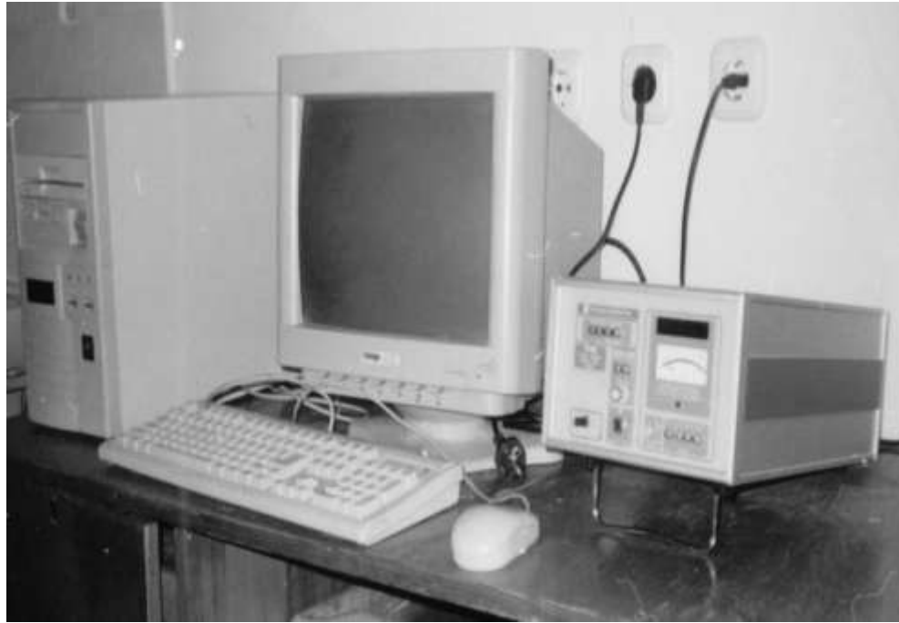
Рис.2.1 Флоуметр (вимірювач об'ємної швидкості кровотоку) Transonic Animal Research Flowmeters T 106 Series (USA).
