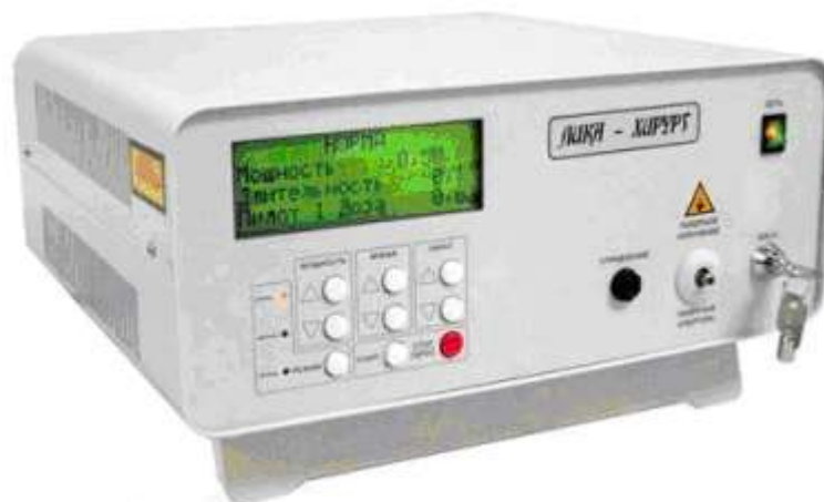
Рис. 5.69. Зовнішній вигляд універсального лазерного коагулятора «Ліка-хірург»
