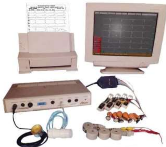
Рис. 1.27. Фонокардіограф комп'ютерний «Сфера».
