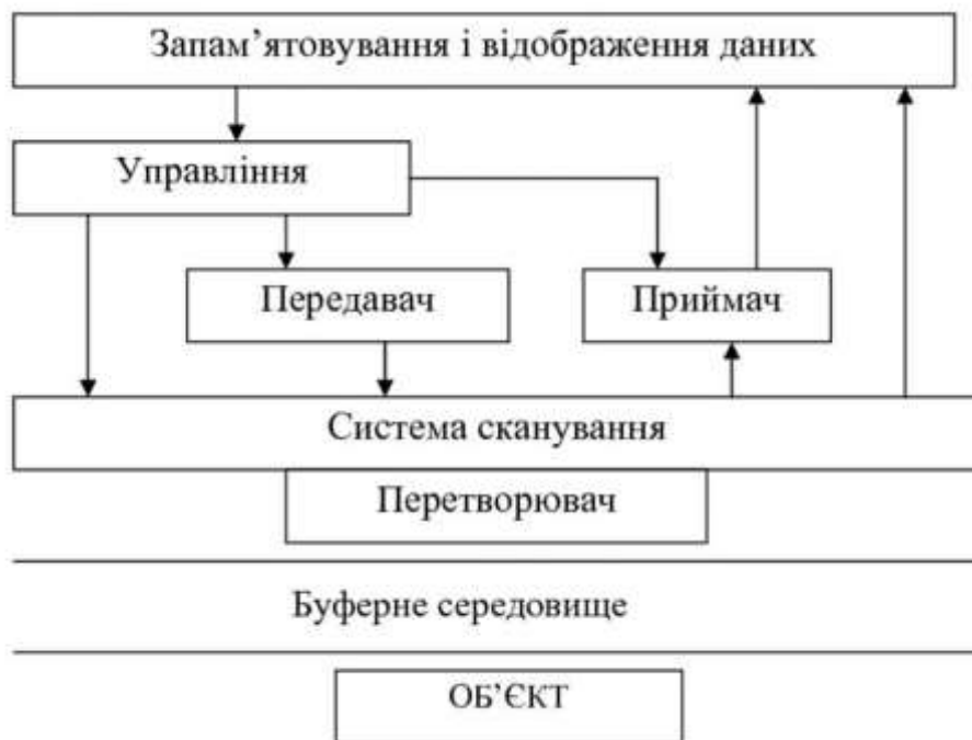
Рис.1.31. Блок-схема, що показує зв'язок між основними вузлами ехоімпульсних діагностичних систем
