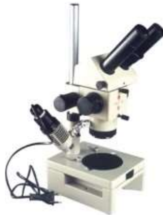
Рис. 5.16. Мікроскоп стереоскопічний МБС-10.
