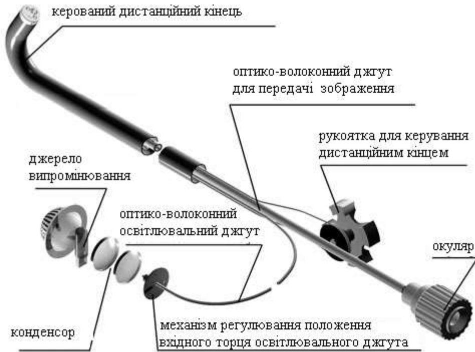
Рис.5.6. Оптико-механічна схема ендоскопа.
