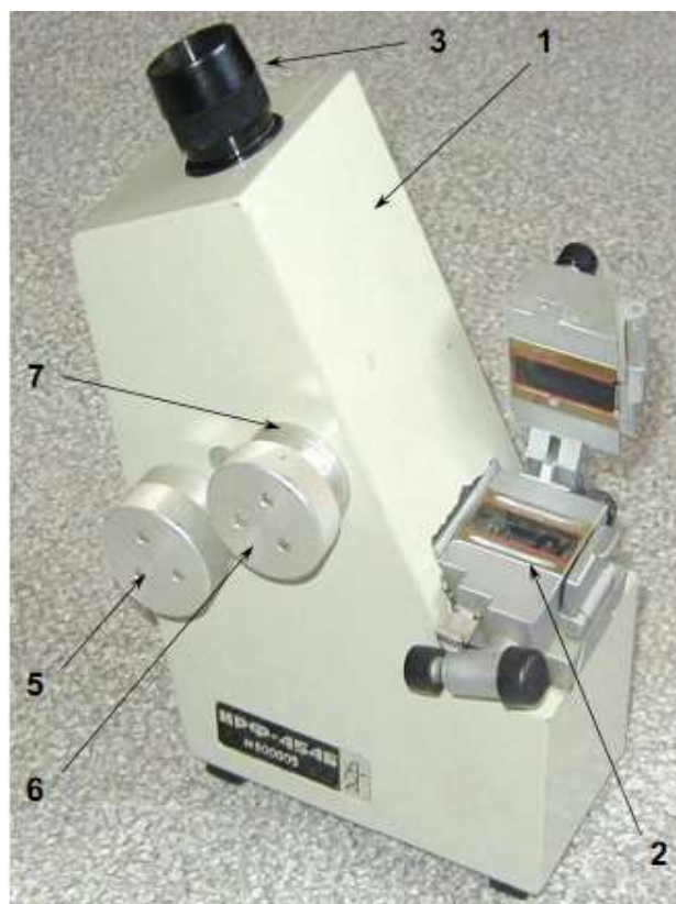
Рис. 5.17. Зовнішній вигляд рефрактометра ИРФ-454.
