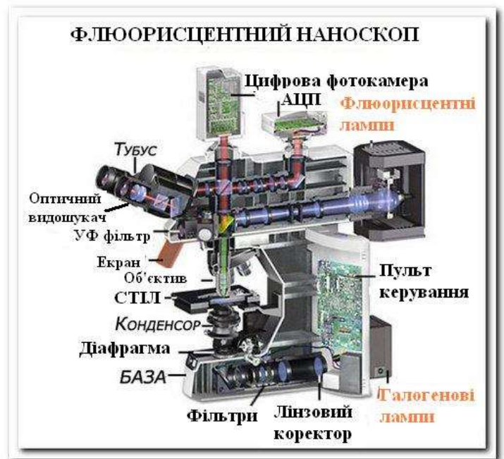
Рис. 6.21. Зовнішній вигляд і будова флюорисцентного мікроскопа
