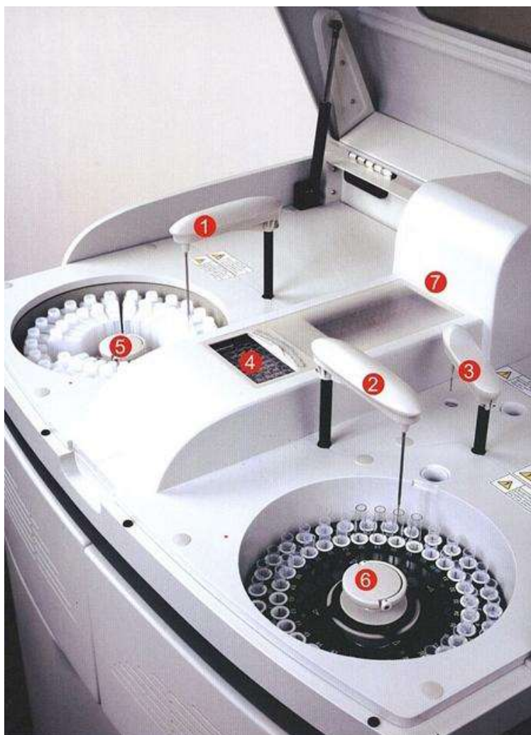
Рис. 8.7. Будова автоматичного хімічного аналізатора
