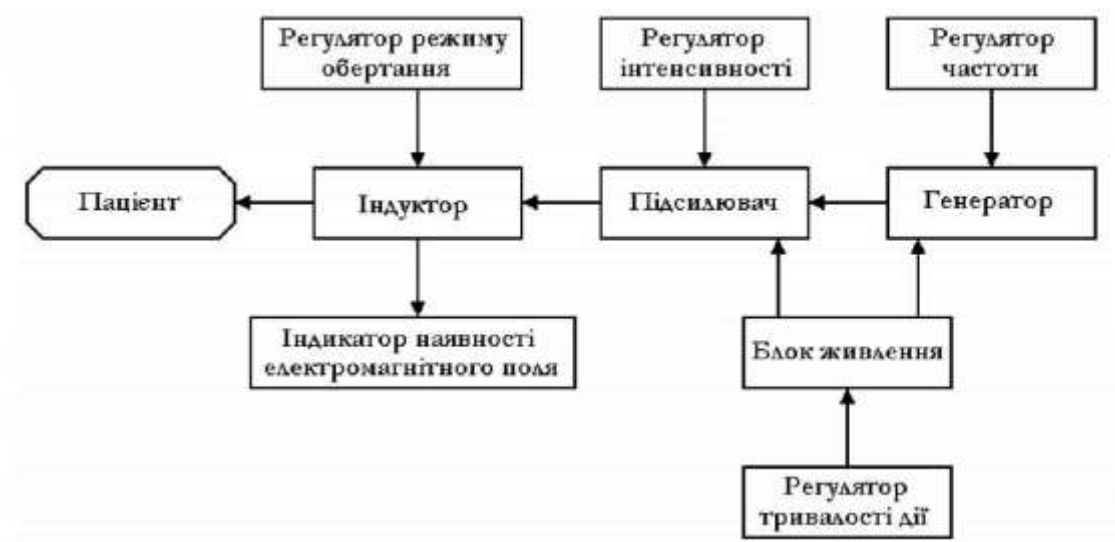
Рис.4.35. Структурна схема приладу Полюс-101
