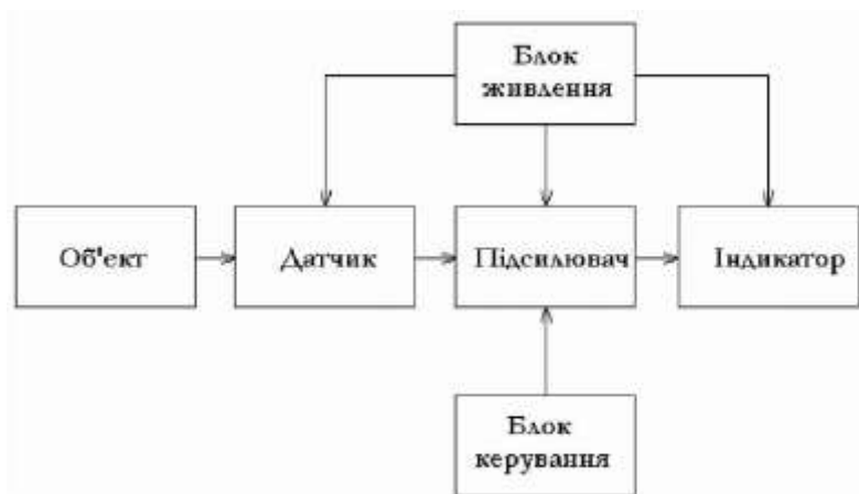
Рис. 4.34. Структурна схема мілітесламетра Ф4356.
