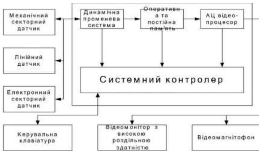
Рис.1.33. Структурна схема типового ультразвукового діагностичного пристрою
