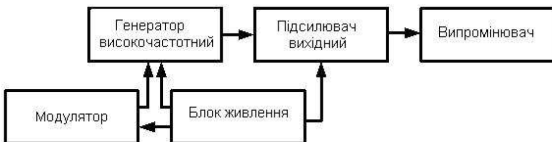
Рис. 1.44 Структурна схема апарата УЗТ
