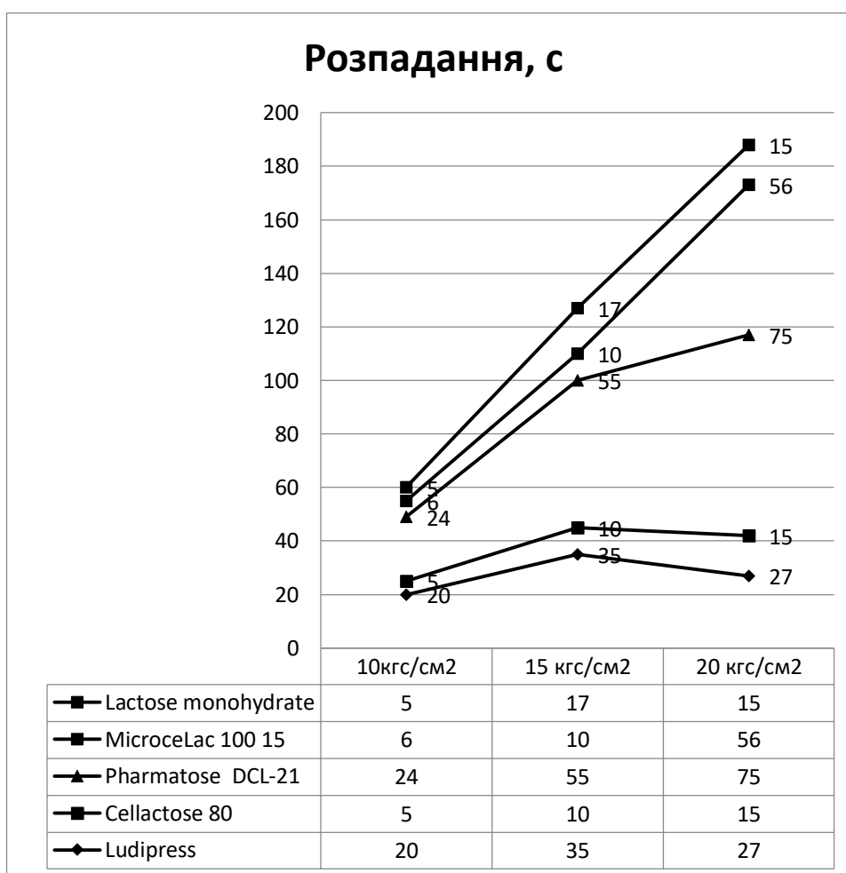
Рис. 3.5. Залежність часу розпадання таблеток від тиску пресування
