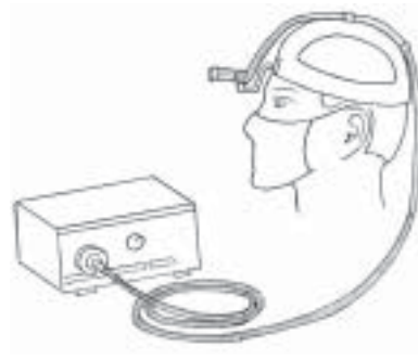
Мал. 20. Налобний освітлювач з волоконнооптичним світловодом.
